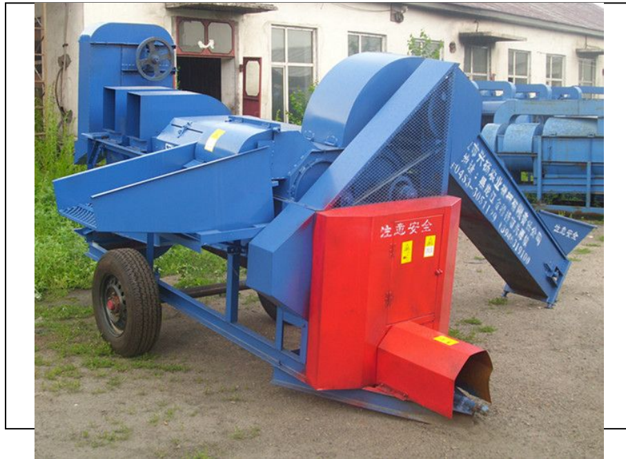
5YT-140 双辊玉米脱粒机
