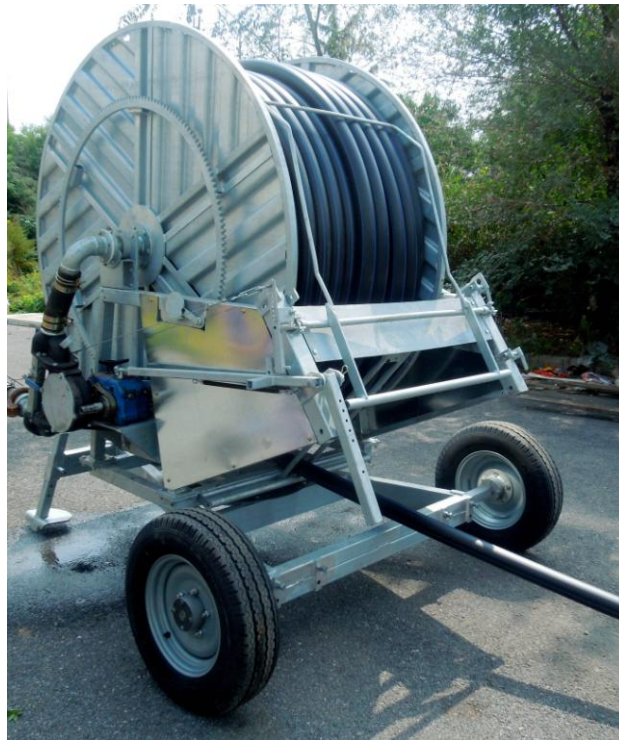
8P-7.5 型 卷盘式绞盘喷灌机
